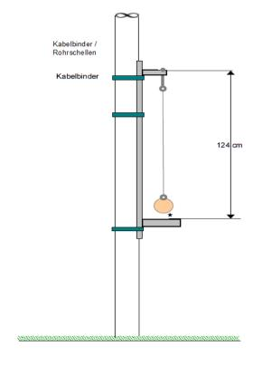
Eine mögliche Kontrolllehre, montiert mit Kabelbinder an einem Pfosten der Netzhalterung
